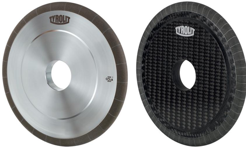
2 Aktuelle Schleifscheiben von Tyrolit, die sich zum Kniegelenkschleifen eignen und sich durch eine kombinierte Weiterentwicklung von Trägerkörper und Schleifbelag auszeichnen. Um sich den individuellen Bedingungen anzupassen, kann der Trägerkörper aus Stahl, Aluminium (links) oder Karbon (rechts) bestehen © Tyrolit
