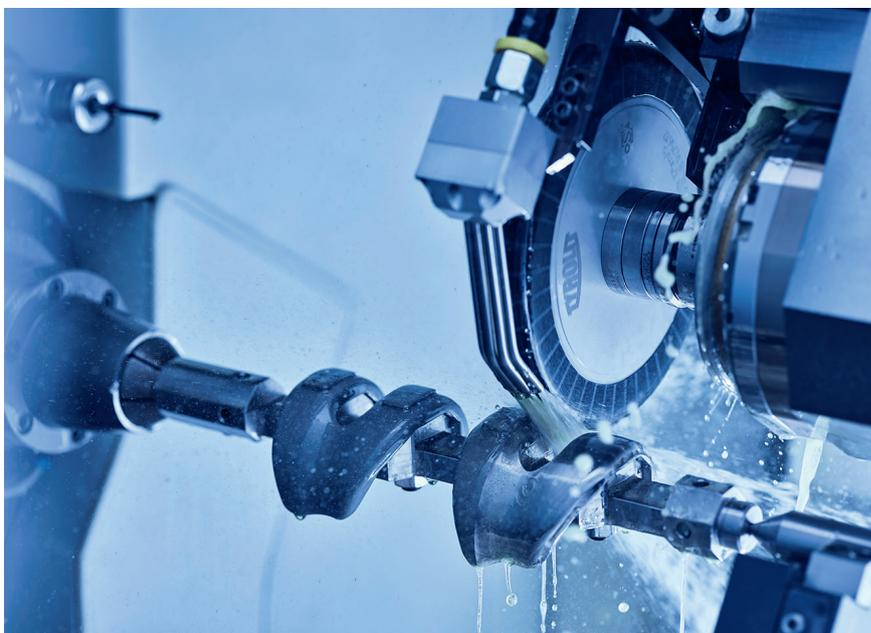
1 Der Produktivitätssprung in der Kniegelenkfertigung gelang mit Tyrolit-Schleifscheiben auf einer Schleifmaschine Schütte 325 linear, die schleifen einschließlich bandschleifen, polieren und abrichten kann, aber auch fräsen (© Tyrolit)
